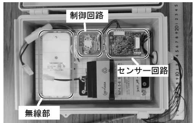
図3 センサー端末 (内部)
